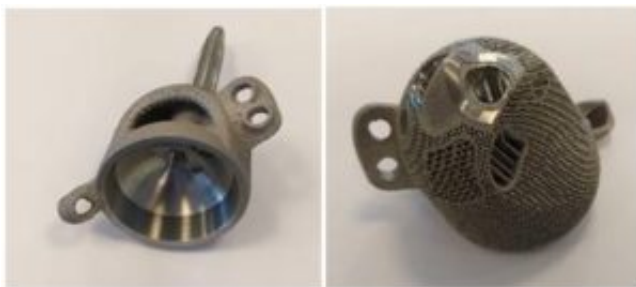
Foto 2: l'impianto definitivo in lega di titanio prima della sterilizzazione
