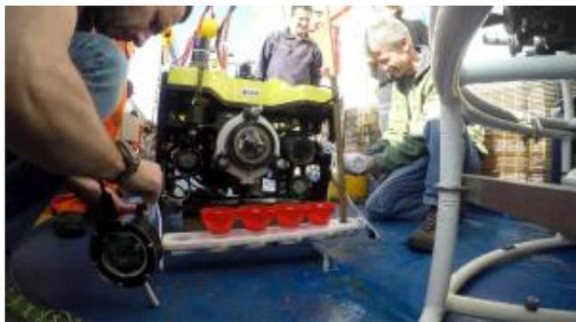
ROV (veicolo subacqueo filoguidato) con sonda per misurare temperatura e prototipo per campionare gas realizzato dai ricercatori dell'INGV di Palermo montato su ROV
