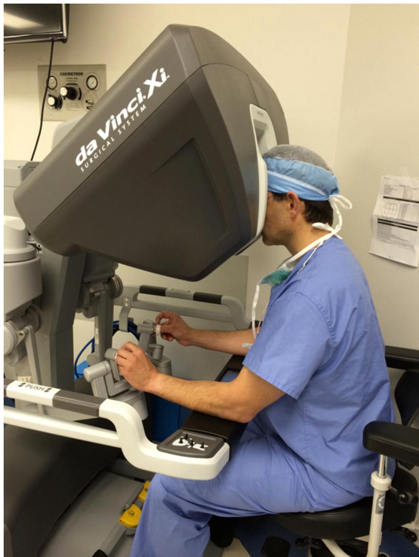
Torino, 3 agosto 2015 – La Città della Salute e della Scienza di Torino acquisisce l'ultimo modello di Robot da Vinci. Si tratta del sistema da Vinci Xi, un'apparecchiatura che permette ad un singolo chirurgo di azionare simultaneamente 4 bracci robotici, consentendogli così di eseguire movimenti estremamente precisi nel corso di interventi chirurgici ad elevata complessità.
