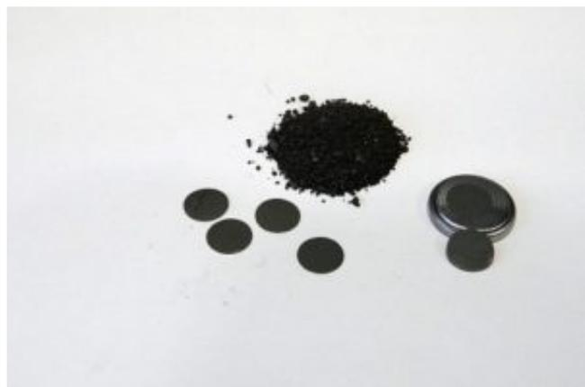
Il team internazionale ha realizzato una nuova batteria che risolve tale problema attraverso l'introduzione di piccole quantità di grafene nell'anodo. Oltre a guadagnare in stabilità, le nuove batterie resistono a oltre 300 cicli e hanno capacità superiori del 30% rispetto alle soluzioni presenti sul mercato.
